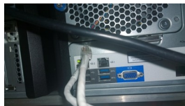
Abbildung 94: Tests / TR1-T0001-1: Der Ethernet - Port 1 wurde im laufenden Betrieb von gfsn1.mgntdom ausgesteckt.
