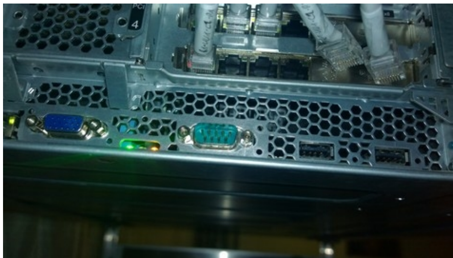
Abbildung 101: Tests / TR1-T0003-2: Trennen der Ifaces igb9 und igb 10 von der pfSense Firewall in laufendem Betrieb. Iface igb11 bleibt Online.
